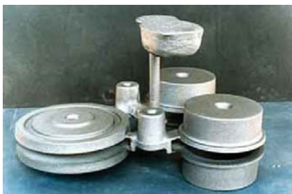
Рис.27. Отливка, полученная методом формовки с помощью средней формы
