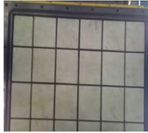
Рис. 30. Облицованные тефлоном рабочие плунжеры и корпус цилиндров многоплунжерной головки гидравлического прессования
