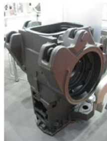
Рис.25. Чугунная отливка корпуса коробки передач заднего моста, масса 730 кг. Завод Luitpoldhutte, Германия
