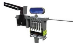
Рис. 3. Шаг 2 – применяется процесс уплотнения форм воздушным потоком по технологии Сейатцу-процесс
