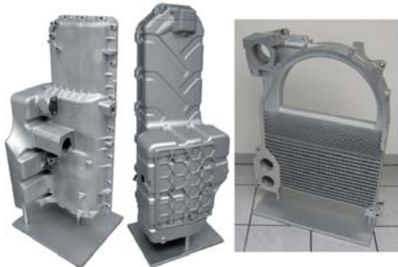
Рис.24. Алюминиевые отливки поддона картера (масса 33 и 31 кг), радиаторов и др.
