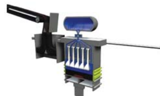
Рис. 4. Шаг 3 – последующее уплотнение многоплунжерной головкой
