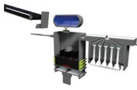
Рис. 2. Шаг 1 – заполнение опоки песчано-глинистой смесью из бункера-дозатора
