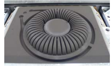
Рис.8. Полуформа отливки с шириной ребер около 2,5 мм, диаметр около 400 мм. Прежде для формообразования особо тонкостенных ребер данных отливок использовали дополнительные стержни, сейчас их нет
