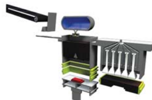
Рис. 5. Шаг 4 – протяжка моделей и выдача готовых полуформ
