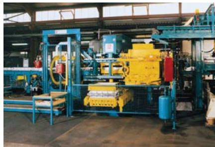
Рис.20. Формовочная машина типа HSP-D и ее схема
