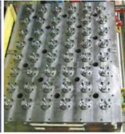
Рис. 30. Облицованные тефлоном рабочие плунжеры и корпус цилиндров многоплунжерной головки гидравлического прессования
