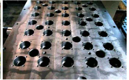
Рис. 30. Облицованные тефлоном рабочие плунжеры и корпус цилиндров многоплунжерной головки гидравлического прессования
