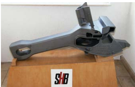
Рис.28. Стальная отливка автосцепки для западно-европейской железной дороги, произведена на заводе SHB Stahl- und Hartgusswerk Bosdorf, Германия. АФЛ HWS-Sinto по Сейатцу-процессу, размер опок 1460x1310x400/400 мм
