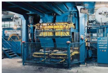
Рис.22. Формовочная машина типа ZFA-SD и ее схема
