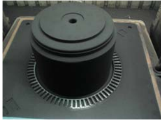
Рис.6. Полуформа по Сейатцу-процессу для отливки тормозного барабана, диаметр около 500 мм
