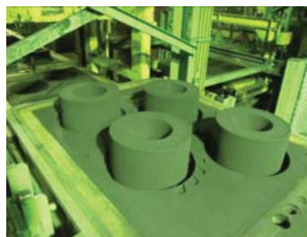
Рис.11. Полуформа низа для отливки тормозного барабана на линии HWS-Sinto по Сейатцу-процессу, размер опок 1500x1100x400/400 мм. В одной форме отливают сразу 4 крупных барабана. Завод КАМАЗ
