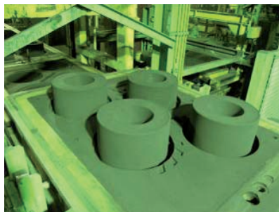
Рис. 1. Полуформы низа для отливки тормозной барабан на одной из двух линий HWS-Sinto в цехе чугунного литья на Литейном заводе «КамАЗ», опока 1500×1100×400/400 мм
