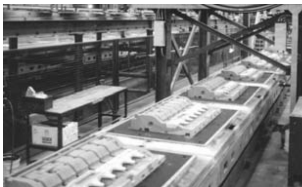
▲ Рис. 1. Часть линии HWS-Sinto с нижними полуформами с установленными в них стержнями
