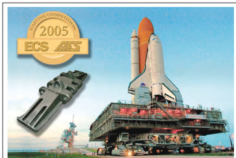
Рис. 2. Трак для тягача космического «Шаттла» массой 998 кг – лучшая отливка 2005 г., согласно решению Ассоциации литейщиков США. Изготовлена на заводе ME Electmettal, США, по технологии ВПФ, взамен ранее применяемых технологий ХТС и ПФ.
