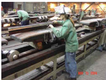
Рис.16. Проверка отливки на плоскостность
