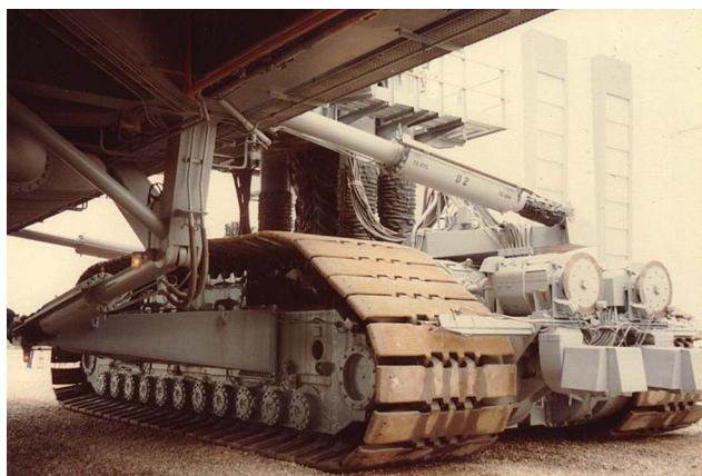
Рис. 18. Действующая конструкция гусеничной подвески транспортера космических кораблей США
