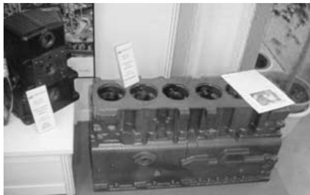
▲ Рис. 3. Отливка блок цилиндров MTЗ , изготовленная на первой линии HWS-Sinto (выставка "Литмаш-2004")
